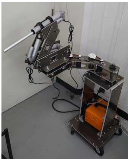
図3 試作したカメラ助手ロボット (ver.1)
