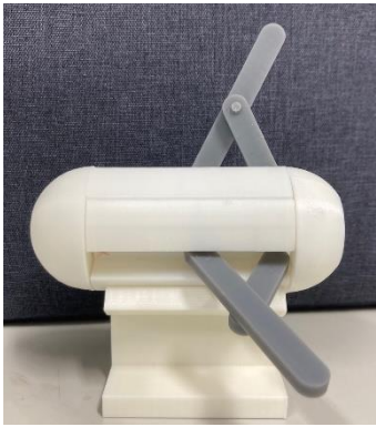
(a) 送りネジ方式による脚部機構の試作
