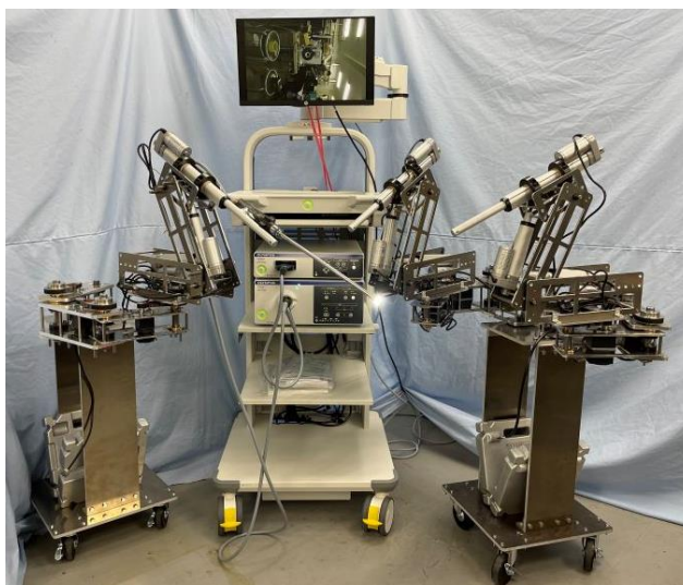
図4 試作した改良版カメラ助手・術野確保ロボット (ver.2)
