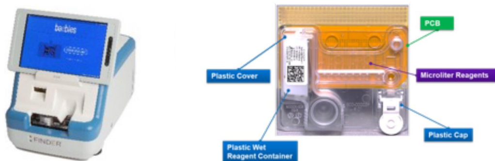
図1 UB測定のための自動測定プロトタイプ機器 (Finder UB値が測定できる)
