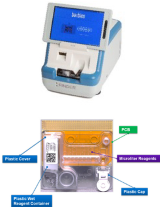
図1 UB測定のための自動測定プロトタイプ機器
