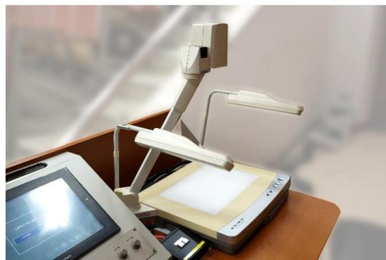
図1 マルティメディア教室に設置された書画カメラ。反射光・透過光を使用できる一方で撮影範囲には制約がある。
