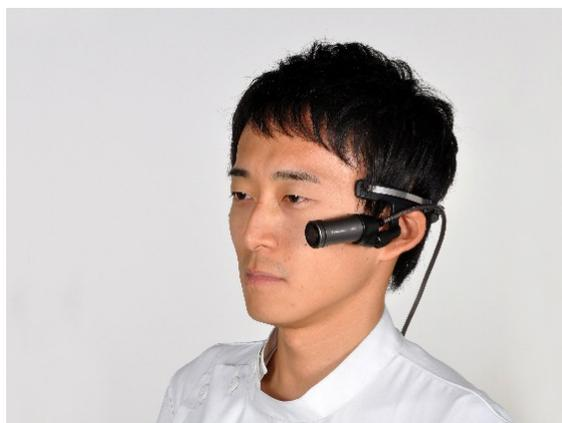
図2 ヘッドマウント装着時のウェアラブルカメラ。ハンズフリーの目線カメラ（Panasonic HX-A500）を用いた場合
