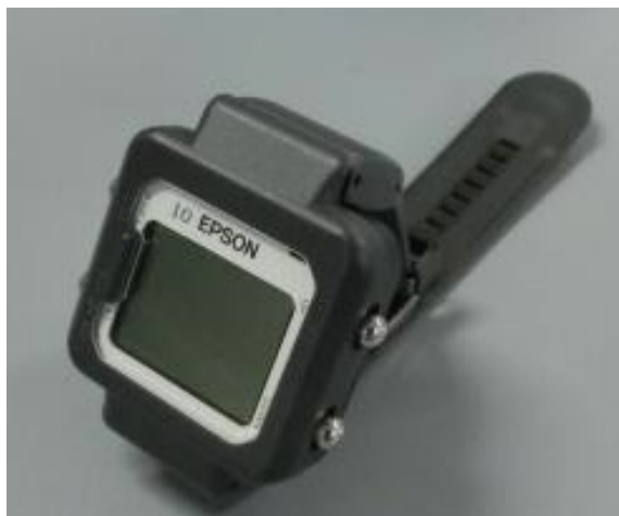
図 1 腕時計型脈波モニタリング機器 (HC1)
