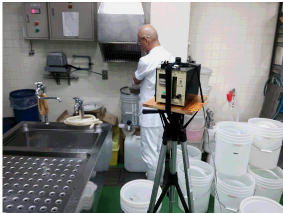
写真1 ホルムアルデヒドの作業環境測定
